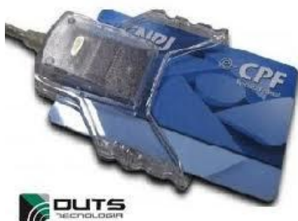
Figura 2-Cartão introduzido na leitora com o chip para cima
